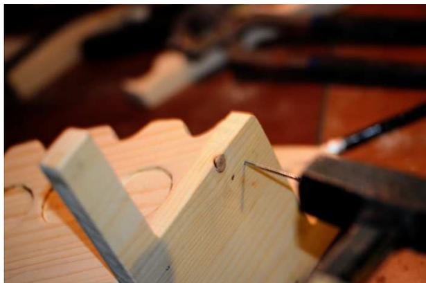
Qui non si possono usare chiodi nè viti perché è un pezzo molto sottile e delicato, io ho usato la colla vinilica e i morsetti, ma forse è più semplice usare il "*Bostik Super Universale*" con cui non servono neanche i morsetti necessari, invece, se si userà la colla vinilica "*Bostik Construct Legno*".
