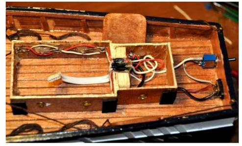
Fissaggio dei led degli oblò sulla parete interna tramite colla a caldo. Collegamento cavi all'interruttore e alla presa alimentatore esterno. Attestazione dei cavi a cavetto connettorizzato (reperibile da un PC in disuso) per aggancio/sgancio rapido con la basetta del circuito cambiicolore e dell'interruttore crepuscolare (dove è stato applicato il maschio del connettore). Bloccaggio cavi con colla a caldo.
