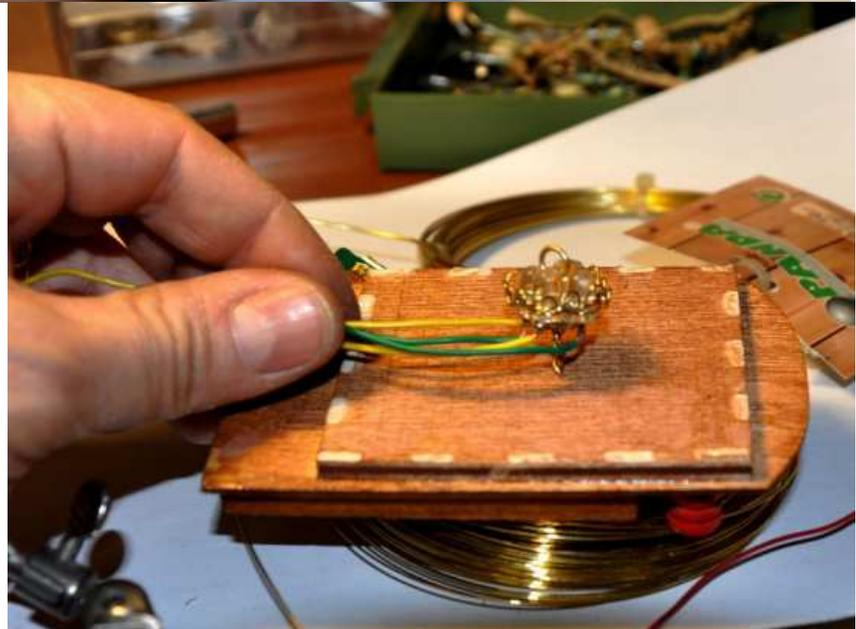
Successivamente va tagliato alla misura voluta il braccetto e posizionato il lampadario sul tetto della cabina dove verrà fissato tramite colla a caldo.
